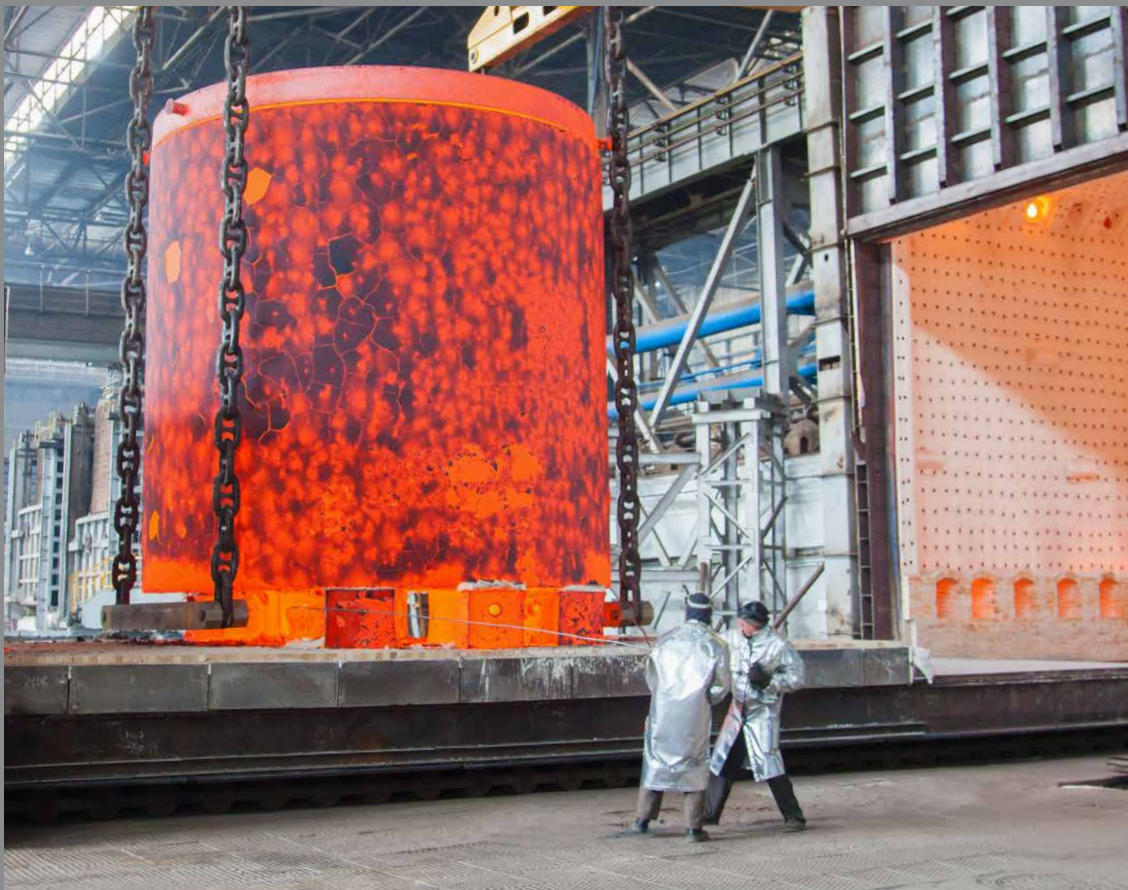
Закалка обечайки ВВЭР-ТОИ АО «Энергомашспецсталь»
