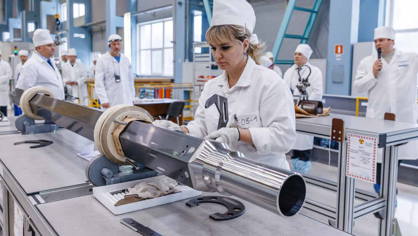
Контроль геометрических размеров ТВС (Машиностроительный завод)
