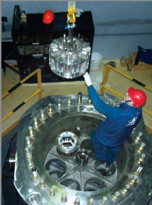
Новый транспортно-упаковочный комплект для перевозки РЕМИКС-топлива, ФГУП «ГХК»
