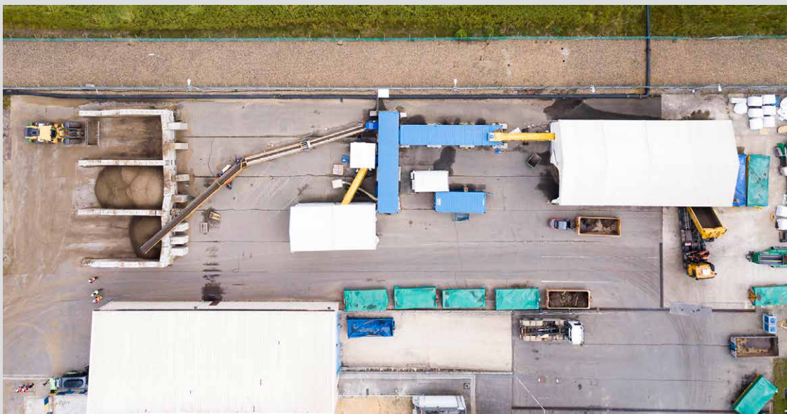
Разделение радиационно-загрязненных сыпучих материалов на конвейере с последующей автоматической сортировкой по заданным предельным значениям на базе радионуклидного вектора.
